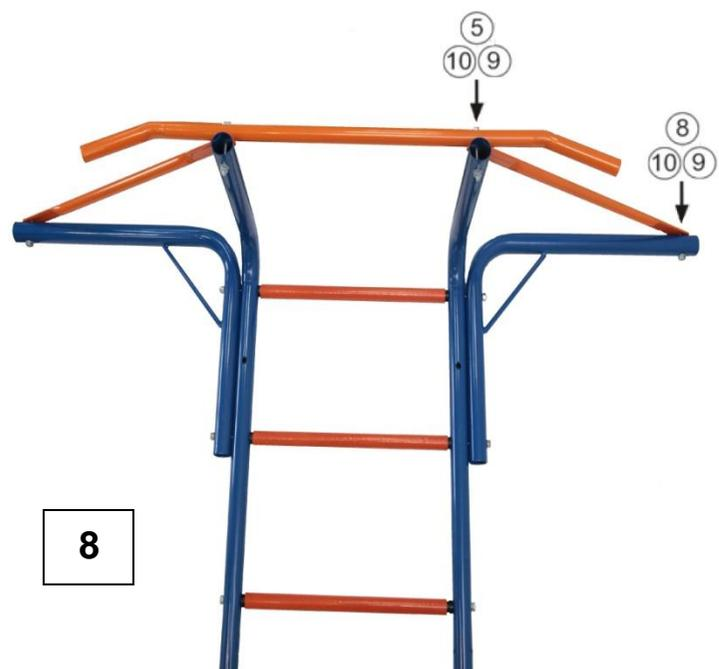
Соберите узел турника, используя болт М8х80 (5), гайку М8 (9), шайбу8 (10) для соединения турника с опорой и болт М8х50, гайку М8 (9), шайбу 8 (10) для соединения распора с Г-образной опорой, рис.8. Затяните все болтовые соединения.
